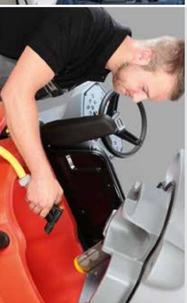
Glatte Flächen im Tank: Das vereinfacht die Tankreinigung und verhindert die Ablagerung von Schmutzresten. Klar gekennzeichnet: Alle Komponenten, die geprüft und gewartet werden müssen, sind gelb gekennzeichnet.
