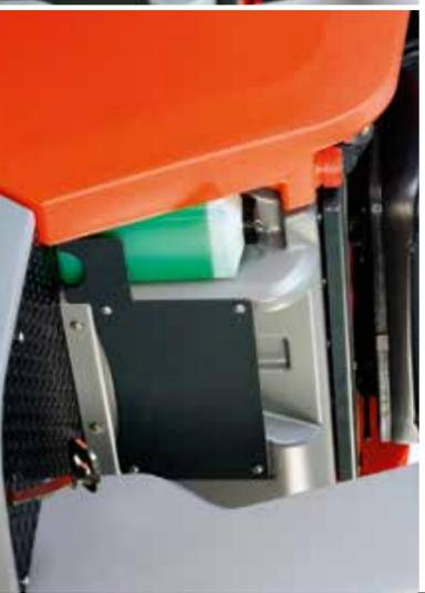
Das On-Board-Dosiersystem sorgt in Abhängigkeit von der Wasserzähluhr für eine optimale Zugabe des Reinigungsmittels – vollständig integriert im Maschinen-Design.
