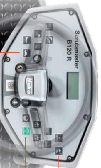
Die Boost-Taste aktiviert die maximale Wasserstufe und den vollen Bürstendruck.
