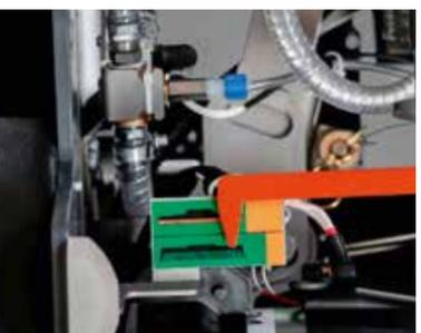
Immer im Überblick: Verschleißanzeiger für Bürsten und Pads. Komfortabler Abwurfmehanismus für den einfachen, schnellen Bürstenwechsel – ganz ohne Werkzeug.
