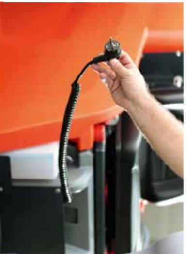
Mit dem On-Board-Ladegerät kann die Batterie an jeder herkömmlichen 220/230V-Steckdose aufgeladen werden.
