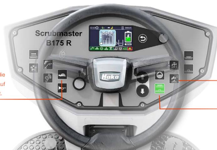
Slow-Modus: Auf Knopfdruck wird die Geschwindigkeit auf 3,5 km/h reduziert.
